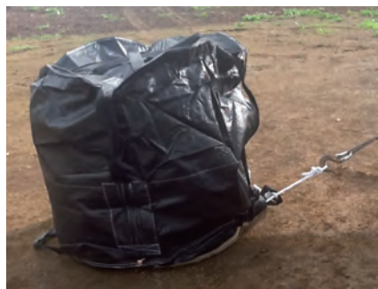
写真4. 吊り上げが無理な通常フレコンは、上部から被せ、180度反転させて詰込
